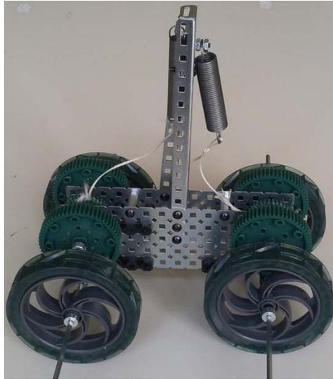
Figure 21 : But du projet : concevoir, fabriquer, et modéliser un véhicule à énergie mécanique pour gravir un plan incliné (Prototype de l'équipe technique)
