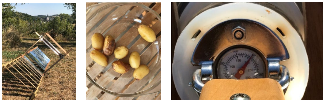
Figure 13 : Cuisson de pommes de terre à l'aide d'un four solaire, atteignant 200°C par bonnes conditions (prototype personnel)
